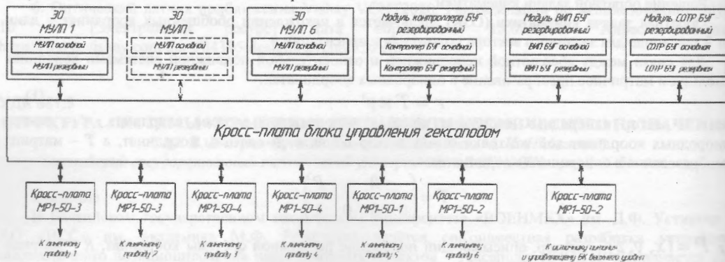
Рис. 2. Схема электрическая структурная блока управления гексаподом
